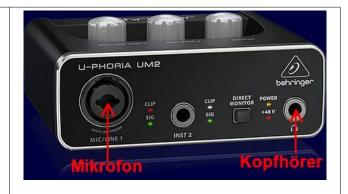
Audiointerface über den USB-Anschluss mit dem Computer verbinden.
